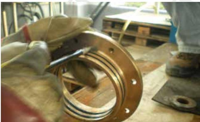
Установка и смазка O-образных колец - 3-ий шаг
