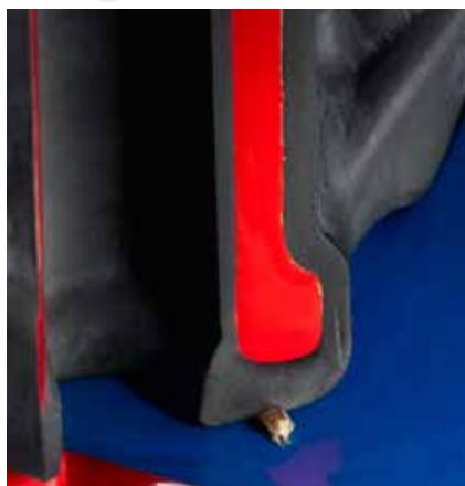
Задвижка с упругим запиранием имеет плоское дно и гладкий проход, через который в нее свободно попадают песок и галька. При закрытии такой задвижки попавший в нее мелкий мусор будет обжат и задержан толстым слоем резины клина.
